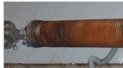
Пружина Компании 3 через 6 месяцев эксплуатации
