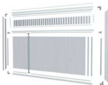
Рис. 1. Конструкция сдвижных ворот с щитом из алюминиевых профилей
