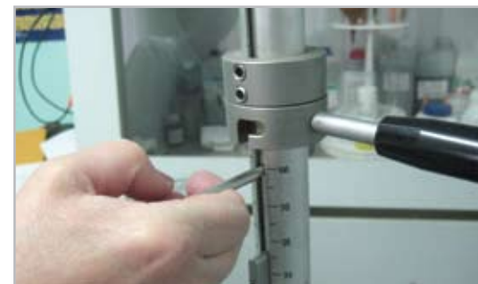
Проверка прочности покрытия
