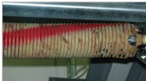
Пружина Компании 3 с антикоррозийным покрытием
