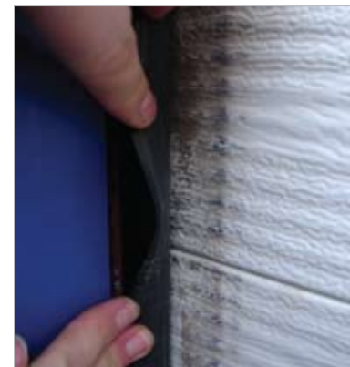
Обдирание панелей уплотнителем Компании 3
