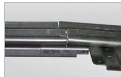
Излом направляющей Компании 3 под нагрузкой
