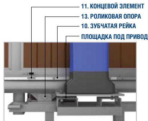
Крепление электропривода к бетонируемой раме
